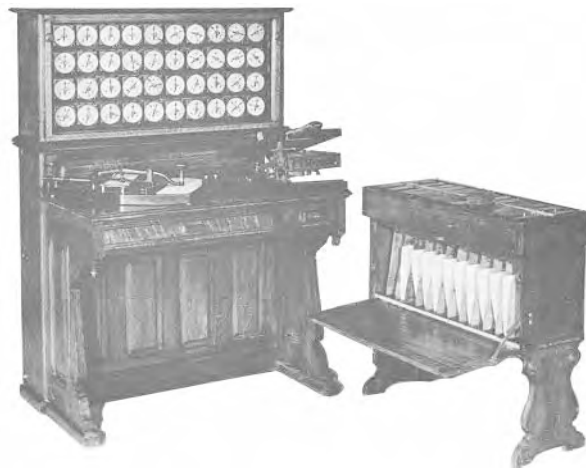
Fig. 1.7 Hollerith Tabulating Machine
