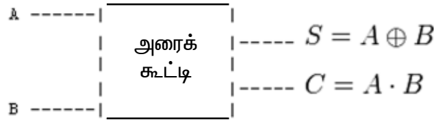
படம் 1.3 (2) அரைக்கூட்டி (Half Adder) EX-OR வாயில் மற்றும் AND வாயில்
